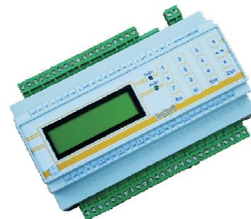
Контроллер осуществляет управление исполнительным механизмом по ПИД-закону регулирования для поддержания заданной температуры приточного воздуха (или температуры в помещении). Имеет дежурный режим работы в течении которого поддерживает температуру теплоносителя в обратном трубопроводе по заданному графику.
