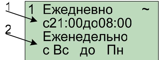
Рисунок 18. Экран расписания режима дежурного отопления (редактируется)
