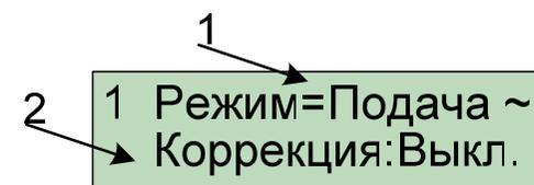
Рисунок 10. Экран выбора режимов работы (экран редактируется)
