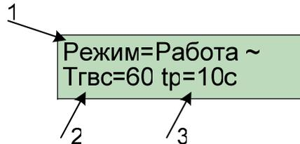
Рисунок 30. Экран выбора режимов работы (экран редактируется)
