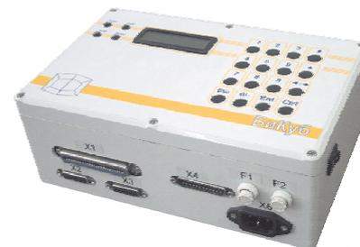
Контроллер «БиКуб-РТ33» предназначен для управления узлами регулирования индивидуального теплового пункта. Контроллер осуществляет управление исполнительным механизмом регулирующего клапана и парой смесительных насосов. Управление исполнительным механизмом осуществляется по ПИД-закону регулирования, а управление насосами включает функции АВР и периодического чередования.
